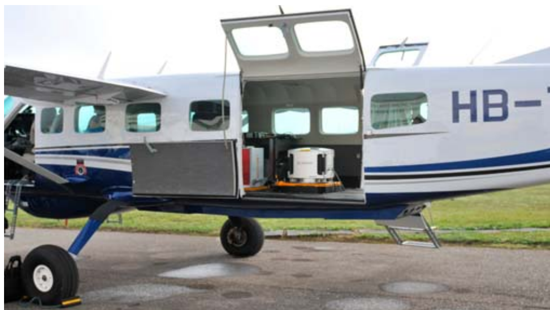
Le lidar est installé dans un avion. SP - SWISS FLIGHT SERVICES - COLOMBIER/FLOTRON - MEIRINGEN
