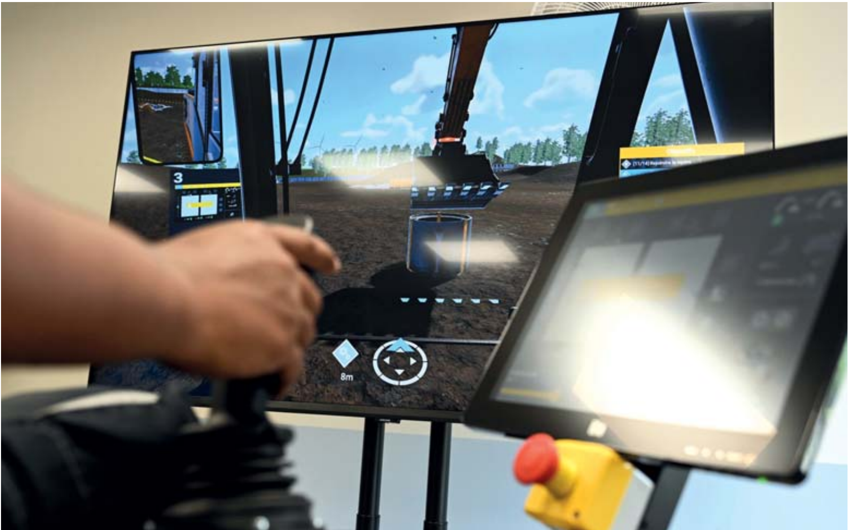
Une vue des simulateurs de conduite d'engins (Acreos), des simulateurs qui permettent une immersion « plus vraie que nature » grâce aux postes de pilotage et à l'environnement de chantier en réalité virtuelle. Au total, un investissement conséquent pour apprendre, pratiquer et progresser en toute sécurité.
