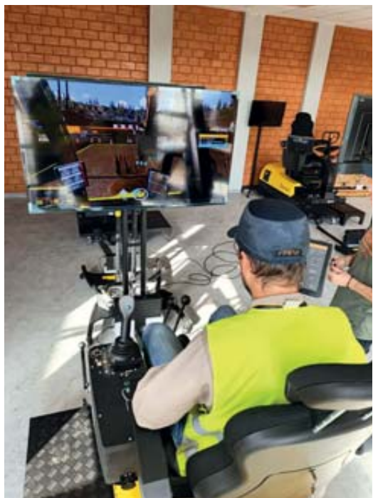
Une vue des simulateurs de conduite d'engins (Acreos), des simulateurs qui permettent une immersion « plus vraie que nature » grâce aux postes de pilotage et à l'environnement de chantier en réalité virtuelle. Au total, un investissement conséquent pour apprendre, pratiquer et progresser en toute sécurité.
