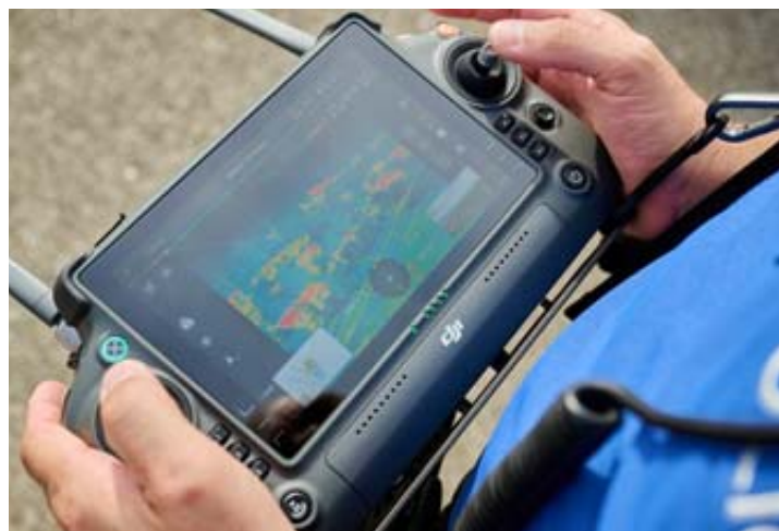
La télécommande permet au pilote de récolter de nombreuses informations, ici l'empreinte thermique du sol.
